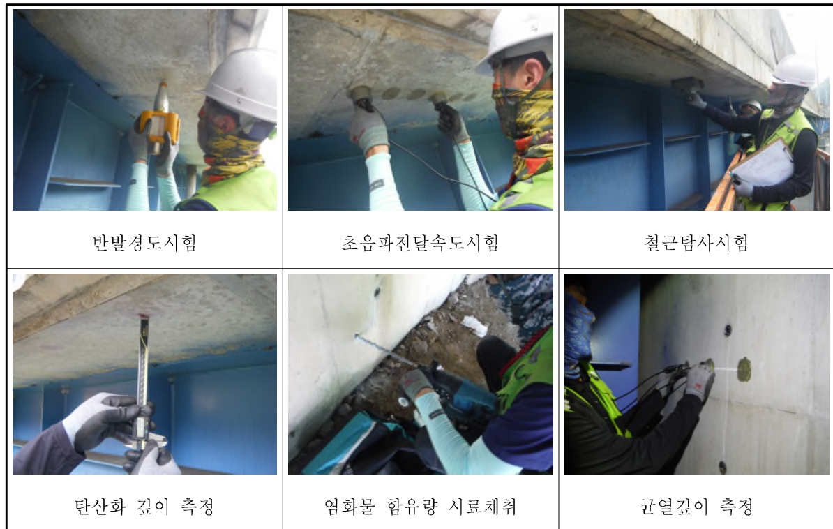
【그림 3.8】 콘크리트 재료시험(부산)
