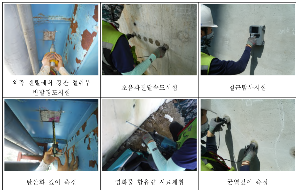
【그림 3.9】 콘크리트 재료시험(춘천)
